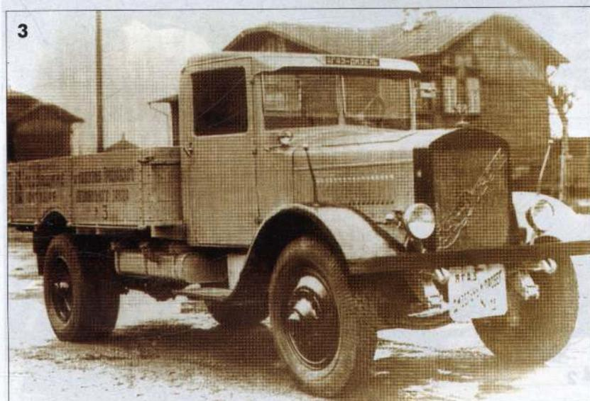
2. «Я-4» (1928 — 1929) комплектовалась дизельными двигателями «мерседес» мощностью 70 л.с. Фото из архива А.С. Исаева
