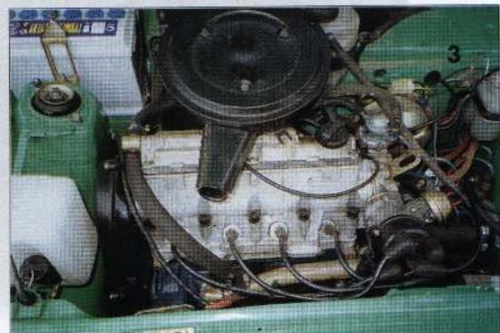
3. Двигатель от «Таврии» планируют устанавливать на машину с изотермическим фургоном
