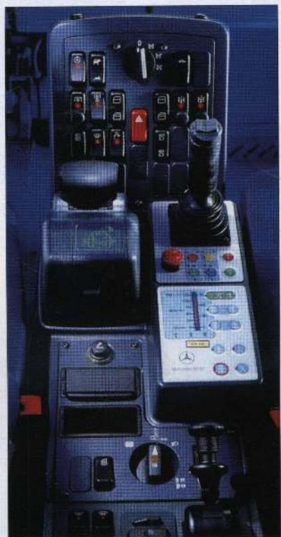
Так выглядят блок управления гидравликой и навесным оборудованием. Слева – джойстик переключения КПП
